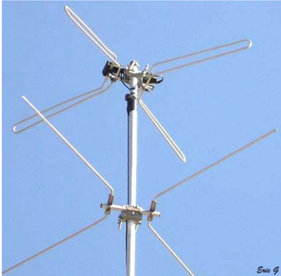
(APT) - antenne 137 Mhz omnidirectionnel double V pour satellites défilants
